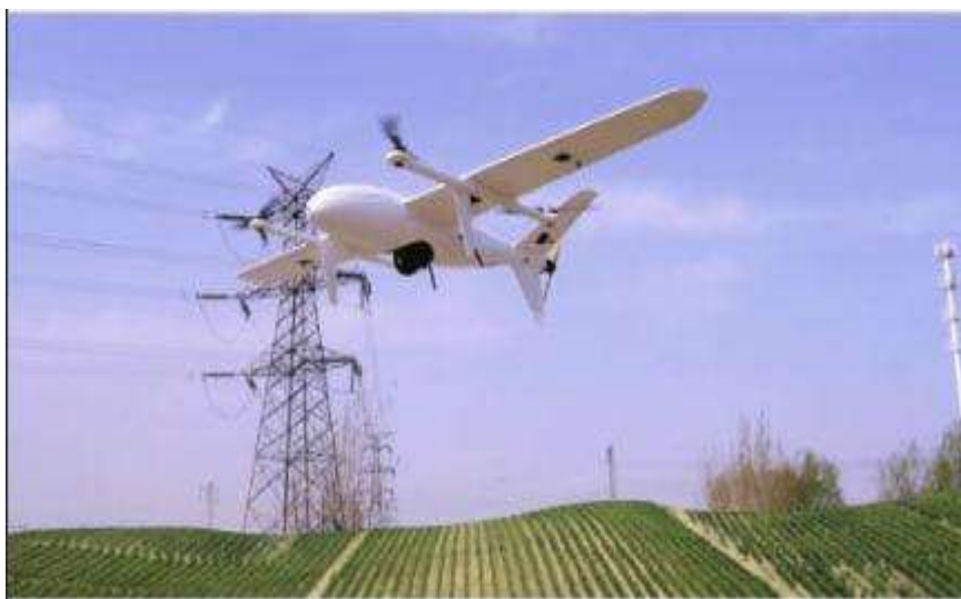
3.1-rasm. Kartografik dron: (Kartografik dron-Foxtech AYK-250 VTOL) surati.
