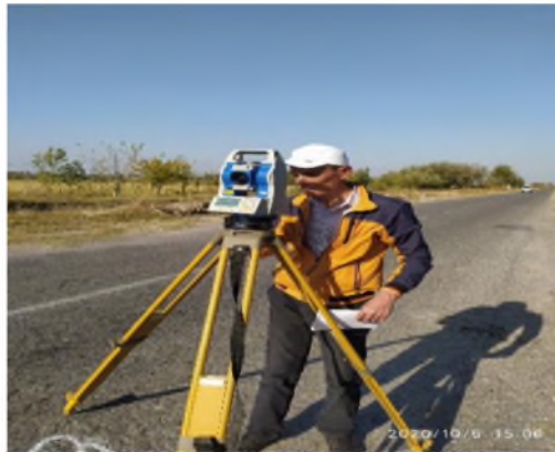
2.2-расм. Маъмурий бирликлар чегараларни электрон рақамли геодезик асбоблар ёрдамида аниқлаш
